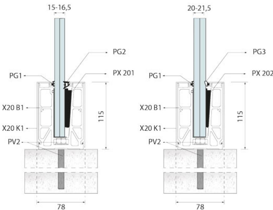
**C** 150 mm'lik (X20 B1) ve 300 mm'lik (X20 B2) bazalarda iç PVC ve sıkıştırma kamaları mevcuttur.
