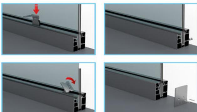
**C** Boy kullanımına göre tasarlanmış bu sistem ekonomik yönü ile ön plana çıkmaktadır. Taşıyıcı baza zemine monte edildikten sonra kama ve civatalar ile cam sabitlenir. Zeminde oluşmuş eğim ve tesviye bozukluklarını boy kullanımı ile kısmen gideren bir özelliğe sahiptir. Hafif yükler için dizayn edilen bu sistemimiz cam üzerinde küpeste kullanımı ile tavsiye edilir. Küpeste modellerimizi 77. ve 78. sayfalarımızda bulabilirsiniz.
