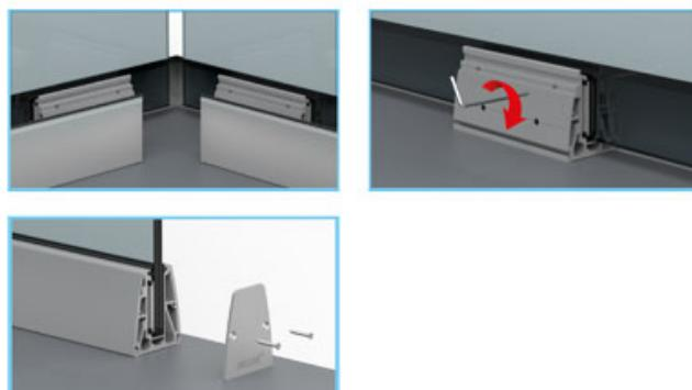
150 mm ve 300 mm parçalar halinde kullanılır. Taşıyıcı bazalar arasında kalan boşluklar max. 300 mm olmalıdır. Daha hafif yükler için dizayn edilen bu sistemimiz cam üzerinde küpeşte kullanımı ile tavsiye edilir. Küpeşte modellerimizi 77. ve 78. sayfalarımızda bulabilirsiniz.
