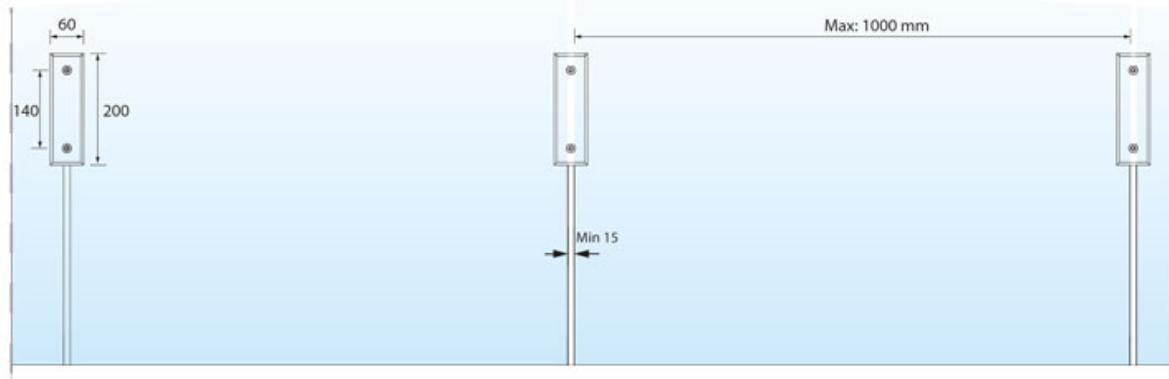
Köşe taşıyıcı dikmeler için cam delme çapı / Glass drilling diameter : Ø 20 mm
