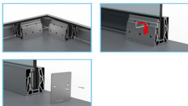
**C** 150 mm ve 300 mm parçalar halinde üretilmektedir. Taşıyıcı bazalar arasında kalan boşluklar max 300 mm olmalıdır. Bu modelimiz ayar kabiliyeti ile uygulama kolaylığı sağlarken, mimari kaygıları da bertaraf ediyor. Sipariş oluşturulurken cam kalınlığı mutlaka belirtilmelidir.
