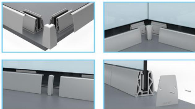
150 mm ve 300 mm parçalar halinde kullanılır. Taşıyıcı bazalar arasında kalan boşluklar max. 300 mm olmalıdır. Oval kapaklı sistemlerde köşe ve ekleme aparatları ile hem montaj kolaylığı sağlar hem de ısı farklarından oluşabilecek genleşmelerden kaynaklanan derz hareketlerini bertaraf etmek için çözüm sunar.
