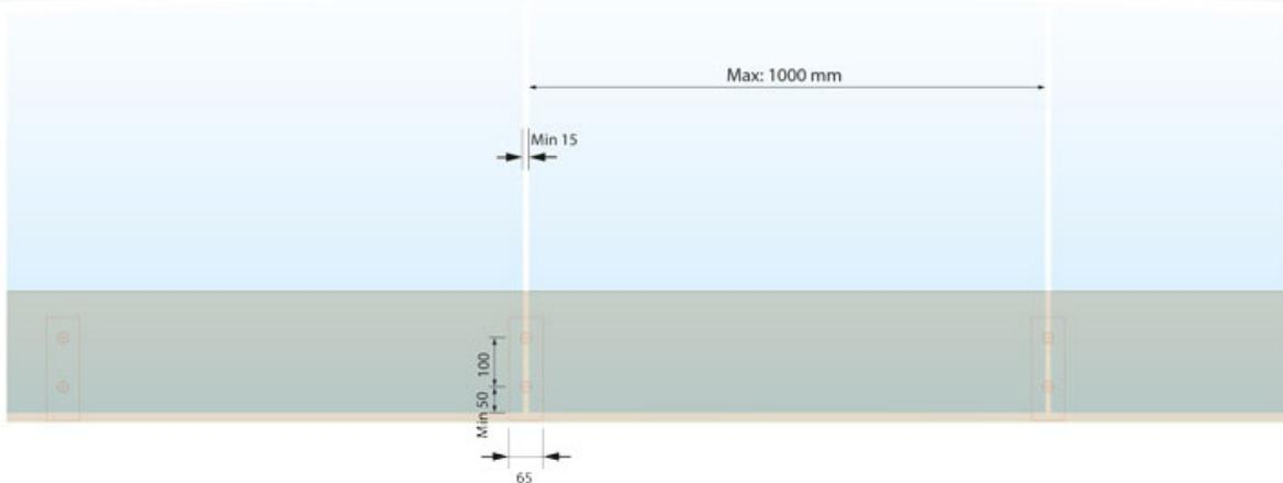
Köşe cam taşıyıcılar için cam delme çapı / Glass drilling diameter : Ø 20 mm
