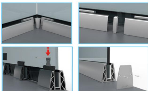
**C.** Tercihe göre; 150 mm ve 300 mm parçalar halinde ya da 3000 mm boy halinde kullanılabilmeye özgünlüğüne sahiptir. Bu modeli X10 ve XV10 modellerinden ayıran yönü cam sabitlemelerinin üstten plastik kamalar yardımcı ile yapılmasıdır.
