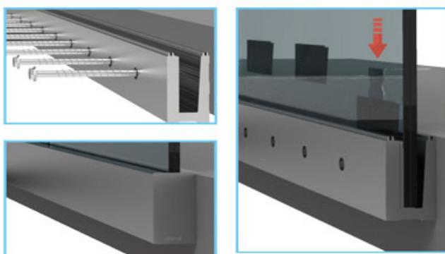
**C.** Sertleştirilmiş dolu alüminyum profilden 3000 mm boyunda ve 250 mm aks aralıkları ile işlenmiş olarak sunulmaktadır. Alından bağlantı özelliği sayesinde mekanlarınızda alan kaybına neden olmaz.
