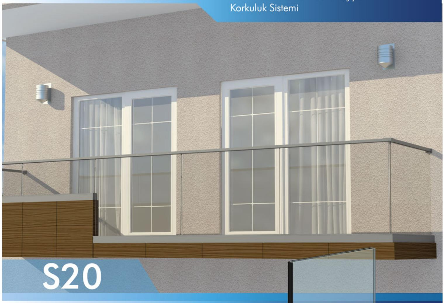
**C** panorama S20, 5+5 mm ya da 6+6 mm camlarda yalnızca boy kullanımına uygun olarak, hafif yükler için geliştirilmiş cam taşıyıcı sistemdir. Camın sisteme sabitlenmesi plastik kamalar ve civatalar yardımı ile oluşturulur.
