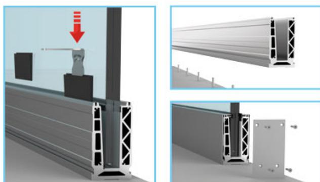
**C.** Sertleştirilmiş alüminyum profilden 3000 mm boyunda ve 250 mm aks aralıkları ile işlenmiş olarak sunulmaktadır. Diğer sistemlere göre statik ve mukavemet değerleri çok daha yüksektir. Bu sistemimizde cam kanalının derinliğinden dolayı 1200 mm yüksekliğe kadar 10+10 mm ya da 12+12 mm temperli lamine camlar kullanılabilmektedir.
