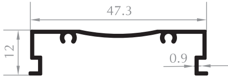
47'LİK DÜZ U Kod/Code :PD1004 Ağırlık/Weight:0,220 kg/m
